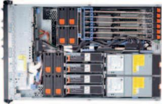
Сервер IBM @server xSeries 366 – первый сервер, созданный на основе IBM @server EXA-3G и 64-битных процессоров Intel Xeon MP с поддержкой EM64T, память DDR2 с поддержкой Active Memory и Active PCI-X 2.0 – нового стандарта высокопроизводительного ввода/
